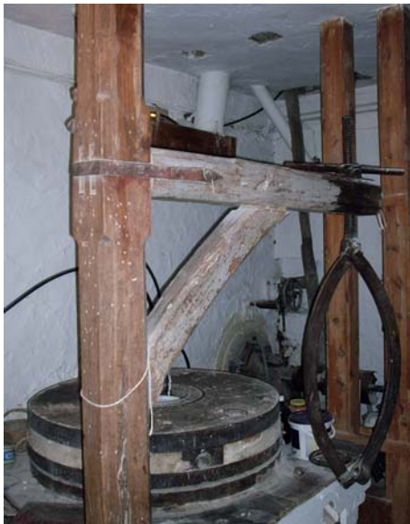
Figura 4. Sala de molienda y detalle de transmisiones mediante engranajes cónicos.
