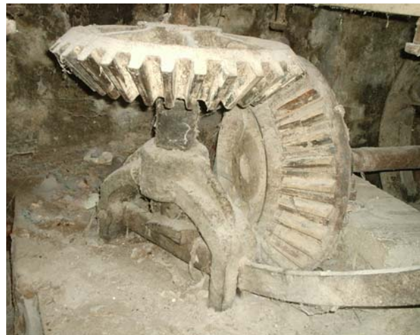
Figura 4. Sala de molienda y detalle de transmisiones mediante engranajes cónicos.
